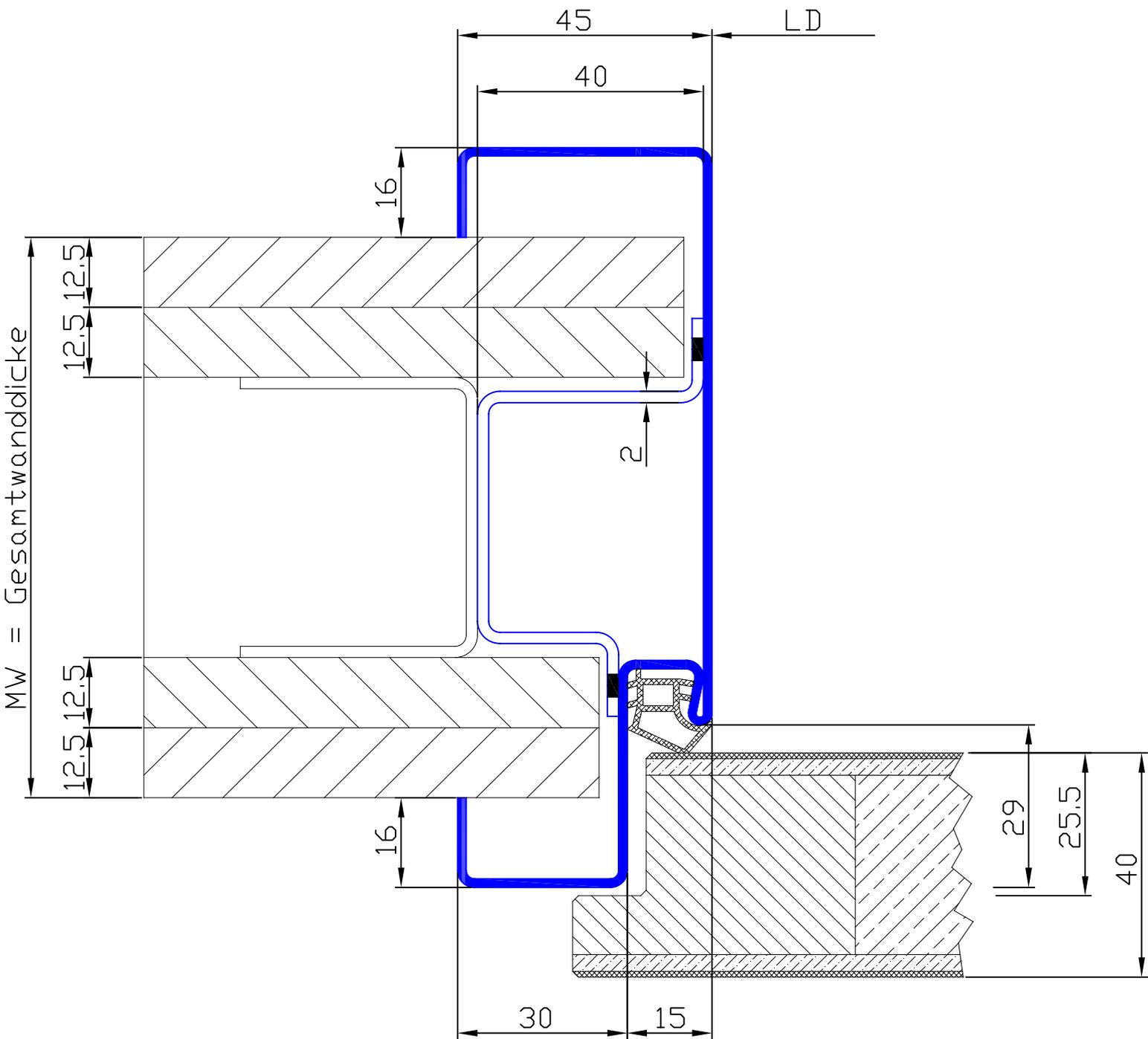
Montage mit selbstschneidenden Schrauben  $\varnothing 6,3$  mm.
